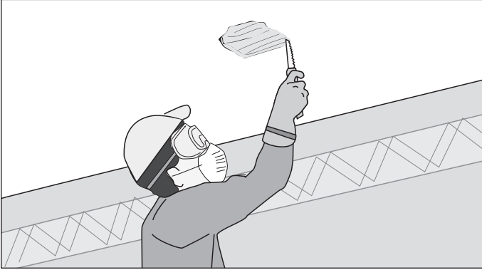
Fig.6.Agrande el orificio preliminar hasta que pueda ver una viga.
