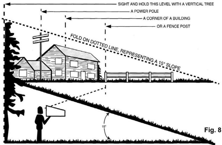
**ADVERTENCIA:** No corte una pendiente que tenga un ángulo superior a  $15^\circ$  (una elevación de aproximadamente  $2\frac{1}{2}$  " [0.75 m] cada 10' [3 m]). Corta la cara de una pendiente, y nunca de arriba abajo.
