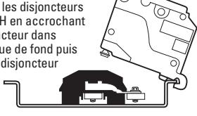
Ramener la manette du disjoncteur complètement en position d'arrêt ("OFF"). Monter les disjoncteurs divisionnaires BR en glissant le pied du disjoncteur sous le rail de la plaque de fond puis enfonçant le disjoncteur sur la lame omnibus.
