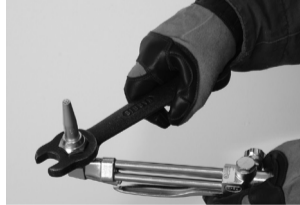
Figura 7. Instalación de la boquilla para cortar
