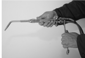
Figura 5. Acoplamiento de la manguera al soplete
