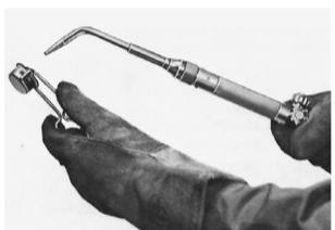
Figura 11. Encendido del gas combustible
