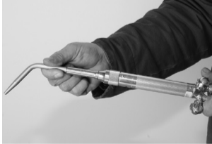
Figura 6. Instalación de la boquilla para soldar
