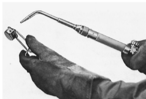
Figure 11. Encendido del gas combustible
