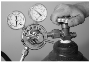
Figura 9. Apertura de la válvula de gas combustible del cilindro
