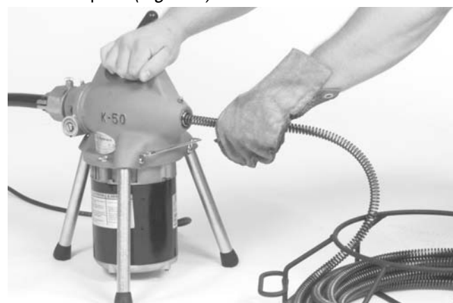
Figura 3 – Introducción del cable por la parte delantera de la máquina
