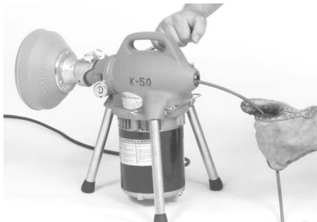
Figure 5 – Montage de l'adaptateur de câble
