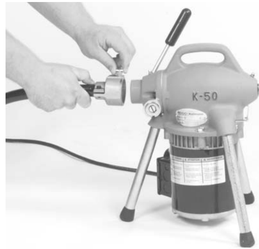
Figure 2 – Montage du guide-câble arrière
