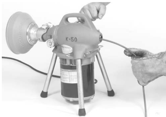
Figura 5 – Acoplamiento del adaptador para el cable
