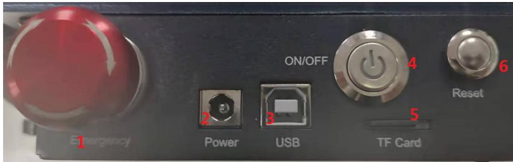
1. Interrupteur d'arrêt d'urgence : en cas d'urgence, la machine cessera immédiatement de fonctionner lorsque vous appuyez dessus. Lorsque vous devez le déverrouiller, tournez le bouton dans le sens des aiguilles d'une montre pour redémarrer le graveur.
