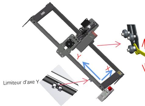
Le rail de guidage passe au milieu des 3 galets. Desserrez la distance entre les roues de guidage supérieure et inférieure de manière appropriée.
