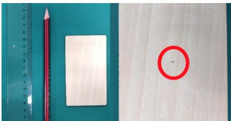
Bild 1 Zeichnen Sie einen Mittelpunkt auf dem gravierten Objekt
