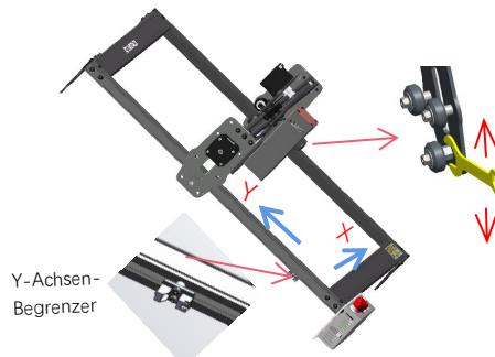
Die Führungsschiene geht durch die Mitte der 3 Rollen. Lösen Sie den Abstand zwischen den oberen und unteren Führungsrädern entsprechend.
