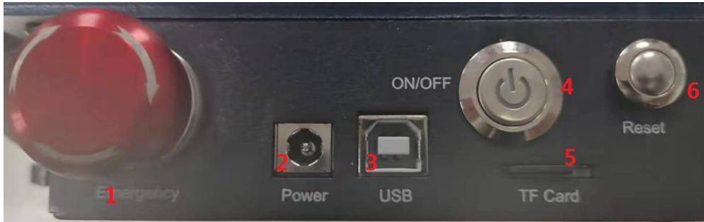
1. Not-Aus-Schalter: Im Notfall stoppt die Maschine sofort, wenn Sie sie drücken. Wenn Sie es entsperren müssen, drehen Sie den Knopf im Uhrzeigersinn, um den Gravierer neu zu starten.
