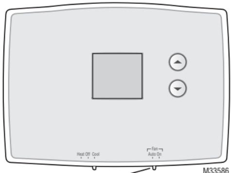
Mueva el interruptor “FAN” hasta la posición “Auto” u “On”.
