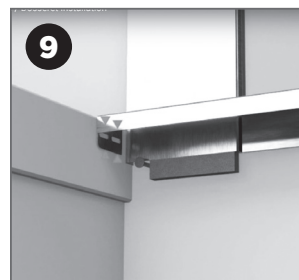
9 Place the moulting in position & level with the countertops & mark the holes on the counter edge. Drill the holes w/ 1/16" bit & attach moulting w/ the screws provided. Placer la moulure de niveau avec le comptoir et y marquer les trous. Percer les trous avec une mèche de 1/16" et fixer la moulure avec les vis incluses.
