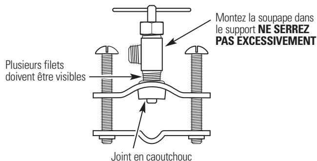
Raccordement optionnel à la source d'alimentation d'eau (avec utilisation de la soupape à bride)\*
