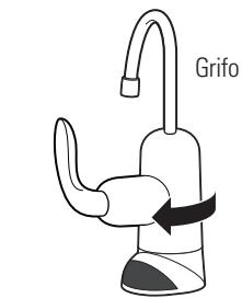
8. Ubique el orificio en la parte trasera de la base. Introduzca el tornillo y comience a ajustar a mano. Termine de ajustar utilizando la llave Allen provista con el paquete. NO AJUSTE DE MÁS.
