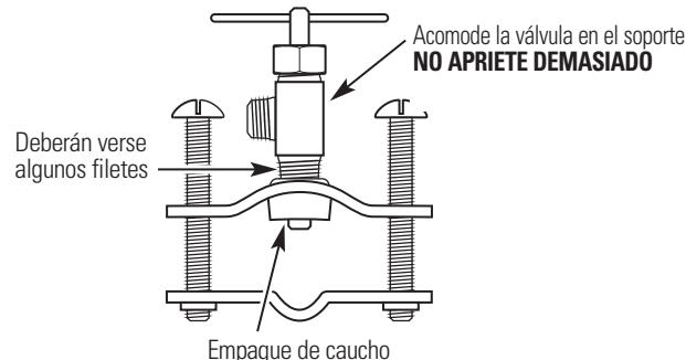
Conexión opcional del suministro de agua (usando válvula de montura)\*
