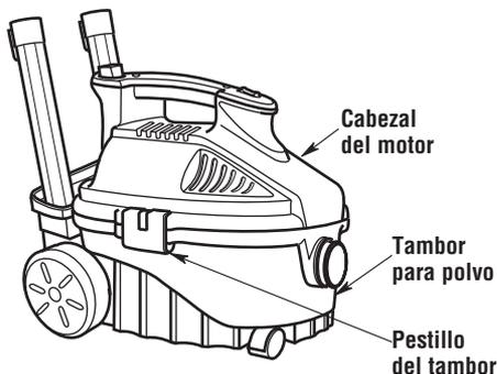
2. Ponga el cabezal del motor en posición invertida sobre un área limpia y seca cuando vacíe el tambor o cambie el filtro.
