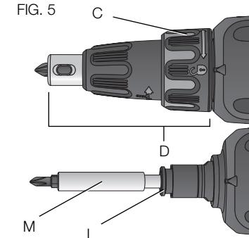
1. Insérez l'embout dans le porte-embout.
