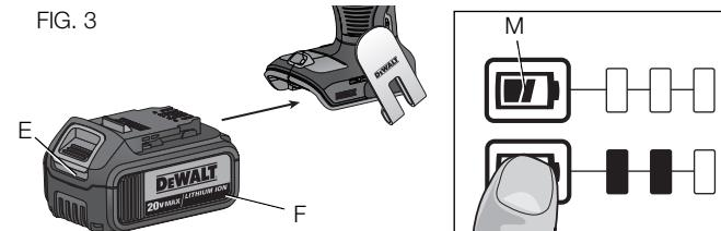
Para retirar la unidad de alimentación de la herramienta, presione los botones de liberación (E) y tire firmemente de la unidad de batería para sacarla del mango de la herramienta. Insértela en el cargador tal como se describe en la sección del cargador de este manual. Apriete el gatillo de la herramienta por tres segundos para disparar la ligera carga eléctrica que pueda quedar aún en la herramienta. La luz de trabajo puede encenderse brevemente.
