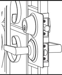
Adjunte su elección de cerraduras con el respaldo de 2-3/8". Extienda completamente los pernos de bloqueo en la posición "bloqueada".
