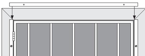
Coloque la jamba de travesaño superior (C) a través de la parte superior de las dos jambas de lado. Asegúrese de que hay un mínimo 1/8" espacio entre la jamba y la parte superior del marco de puerta, y la jamba esté nivelada.
