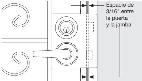
Con los pasadores del cerrojo extendidos, alinear los orificios de cerradura en la jamba del lado de la cerradura (B). Deje aproximadamente 3/16" de espacio entre la puerta y la jamba. Asegúrese de que la jamba esté a plomada, y la parte superior es el nivel de la parte superior de la jamba del lado de la bisagra.
