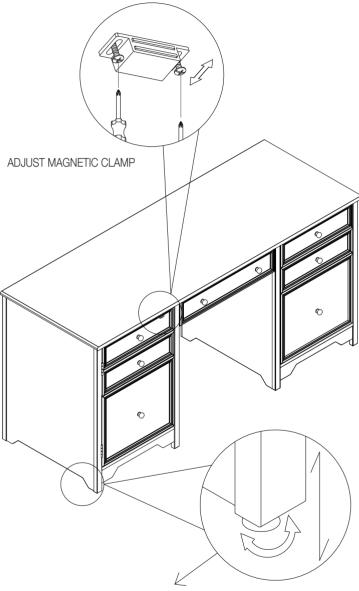
IF THE GROUND IS NOT EVEN THE SIDEBOARD WILL BE UNSTABLE OR THE DOORS UNSYMMETRICAL, YOU CAN ADJUST THE FOOT LEVELER UNDER THE LEG. TURN LEFT TO TIGHTEN, TURN RIGHT TO LOOSEN.
